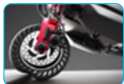
Bezvzduchové pneumatiky NPT absorbujúce nárazy
